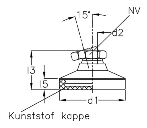
d1 = 50 d2 = 12 l3 = l5 = -NV = 17 Static load (N) = 30 t min = 11.5
